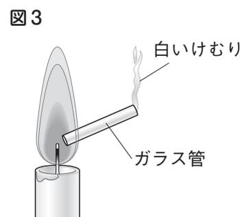
(6) 図3で、細いガラス管を図1の炎のYにあたる部分に入れた場合、ガラス管の先にはどのような変化が見られますか。
